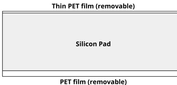
Querschnittsansicht eines Wärmeleitpads mit seinen 2 Schutzfolien auf beiden Seiten. Beide Schutzfolien sind für die Installation des Wärmeleitpads zu entfernen.
