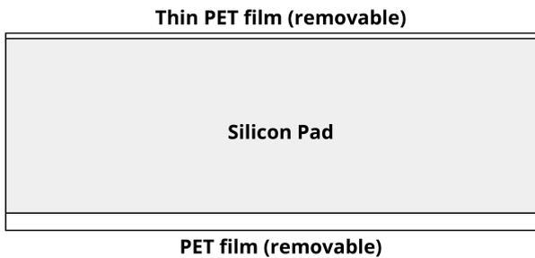
Querschnittansicht eines Wärmeleitpads mit seinen 2 Schutzfolien auf beiden Seiten. Beide Schutzfolien sind für die Installation des Wärmeleitpads zu entfernen.
